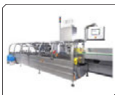
Kartoniarka typ CMH-C. Pozioma kartoniarka (bag in box) do pracy z wydajnością 80-250 kartoników/minutę ROVEMA Polska Sp. z o.o. Pawilon 5, stoisko 57
